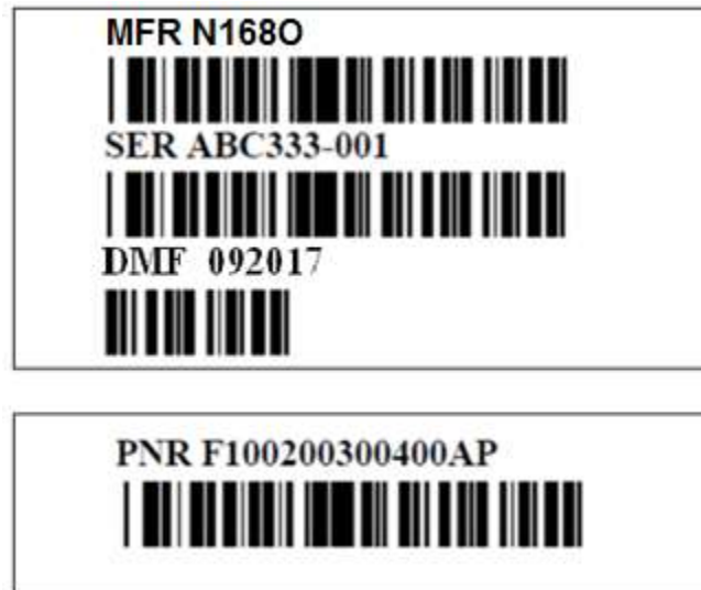
Рисунок 5 – Сокращенный состав данных, линейные символы ШК, поле «PNR» на отдельной табличке
