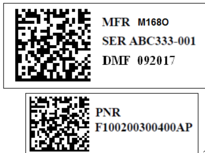
Рисунок 6 – Сокращенный состав данных, матричные символы ШК, поле «PNR» на отдельной табличке
