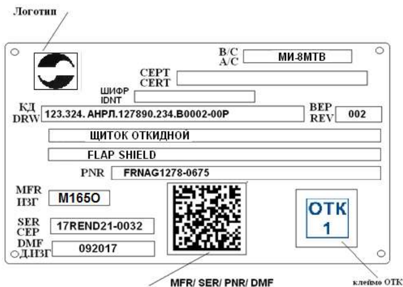
Рисунок 2 – Идентификационная табличка с полным составом данных по [1] для компонента II класса с полем «ШИФР», поле «PNR» на основной табличке в одном символе ШК с данными MFR, SER, DMF
