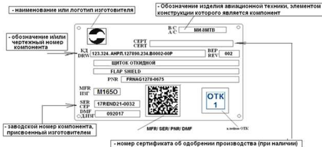
Рисунок 1–Идентификационная табличка с полным составом данных по [1] для компонента BC II класса, поле «PNR» на основной табличке в одном символе ШК с данными MFR, SER, DMF
