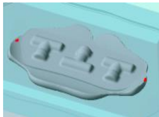
Устранение не заполнения гравюры штампа
