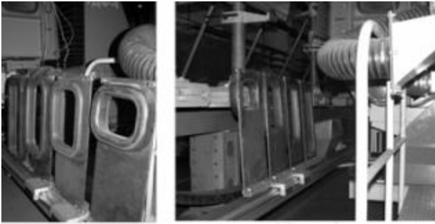
Система смены инструмента: а) и б) – система смены инструмента, установленная на УДФ-4; в) общий вид системы смены инструмента
