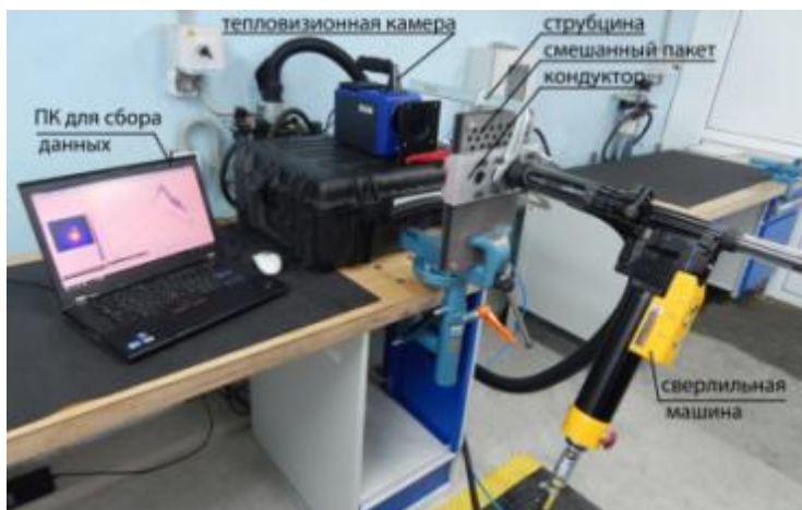
Исследования процесса сверления отверстий в смешанных пакетах
