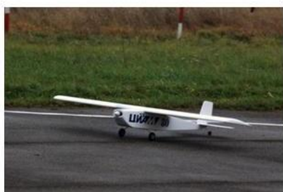
Силовая установка и общий вид первого в России БЛА «ЦИАМ 80» с маршевой силовой установкой на основе топливных элементов
