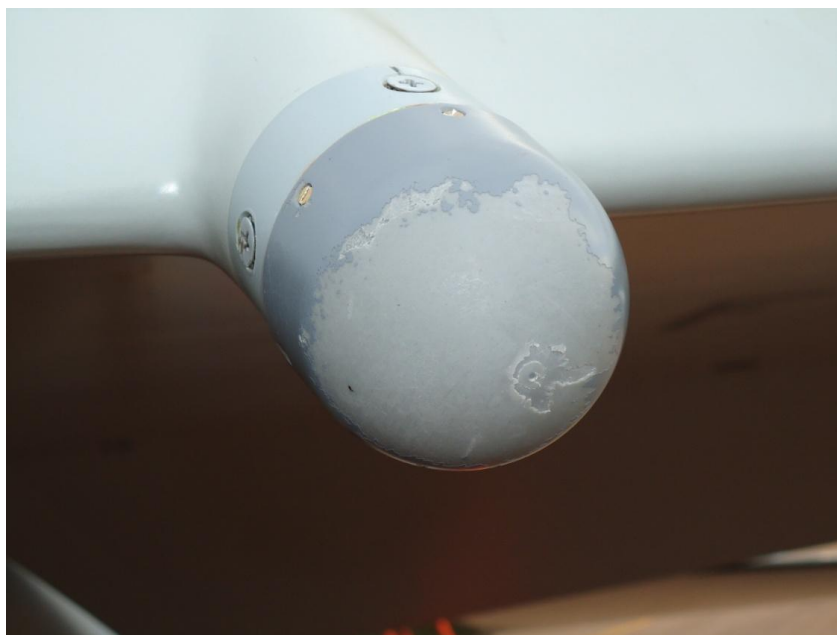
Рисунок 2 – Обтекатель с разрушенным многослойным лакокрасочным покрытием
