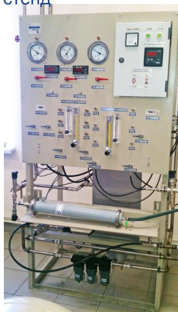
5 Аварийстойкая топливная система – испытательный стенд
