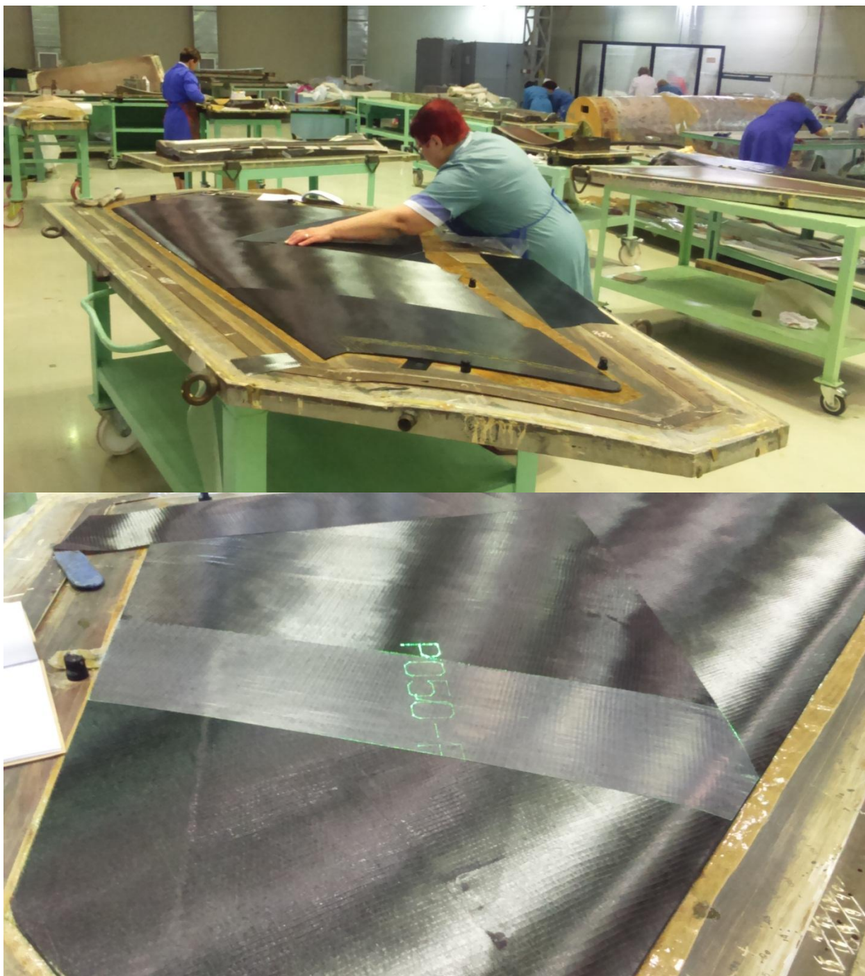
Рис. 33 Процесс выкладки панели кессона киля с использованием проекционной лазерной системы LAP Laser
