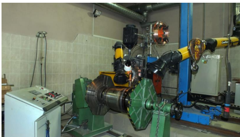
Рисунок 3. - Автоматизированная сварочная установка СГ-АДФ- 1000.
