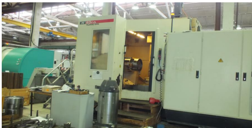
Рисунок 5. - Пятикоординатный фрезерный обрабатывающий центр Н-63.
