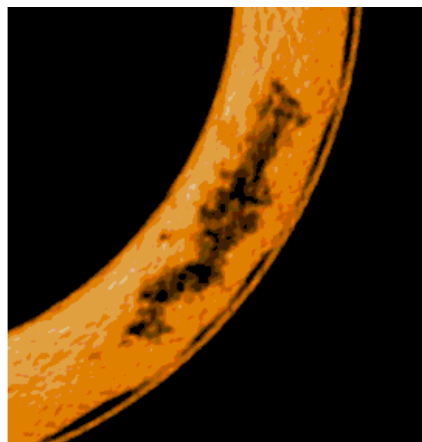
Рисунок 1. - Усадочные раковины в металле, полученном методом традиционного литья.
