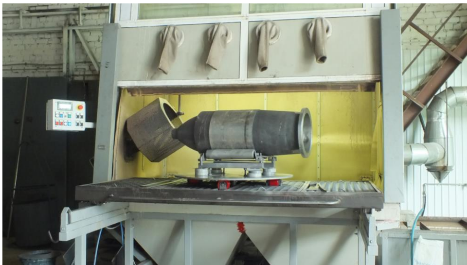
Рисунок 6. - Гидроабразивная установка КОТ-300Э.
