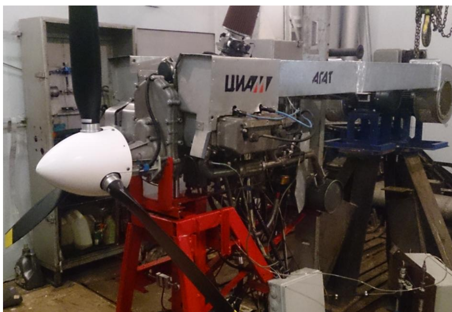
Рисунок 7. Двигатель-демонстратор ПД-1400 на винтовом стенде
