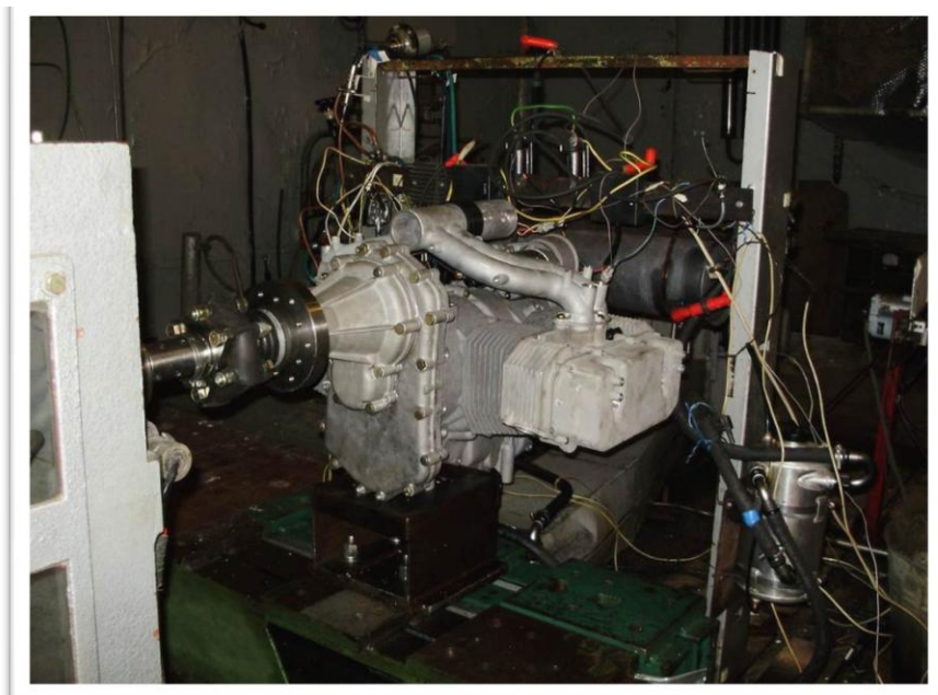
Рис 6. Предварительные испытания двигателя на тормозном стенде
