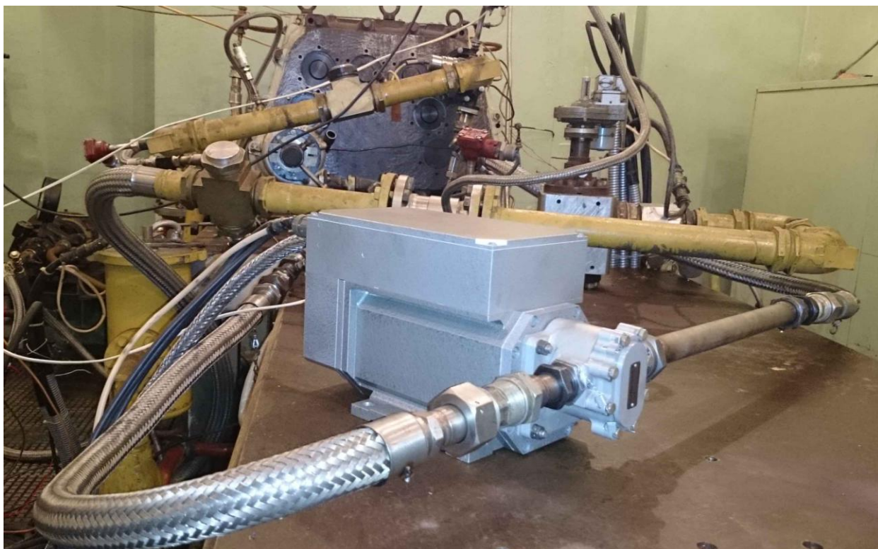
Рис.5 Монтаж электроприводного стенда ГУ-212 ЦИАМ
