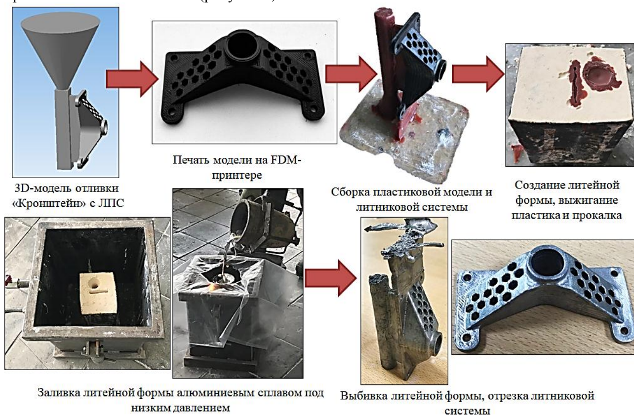
Рисунок 3 – Процесс изготовления детали «Кронштейн»
