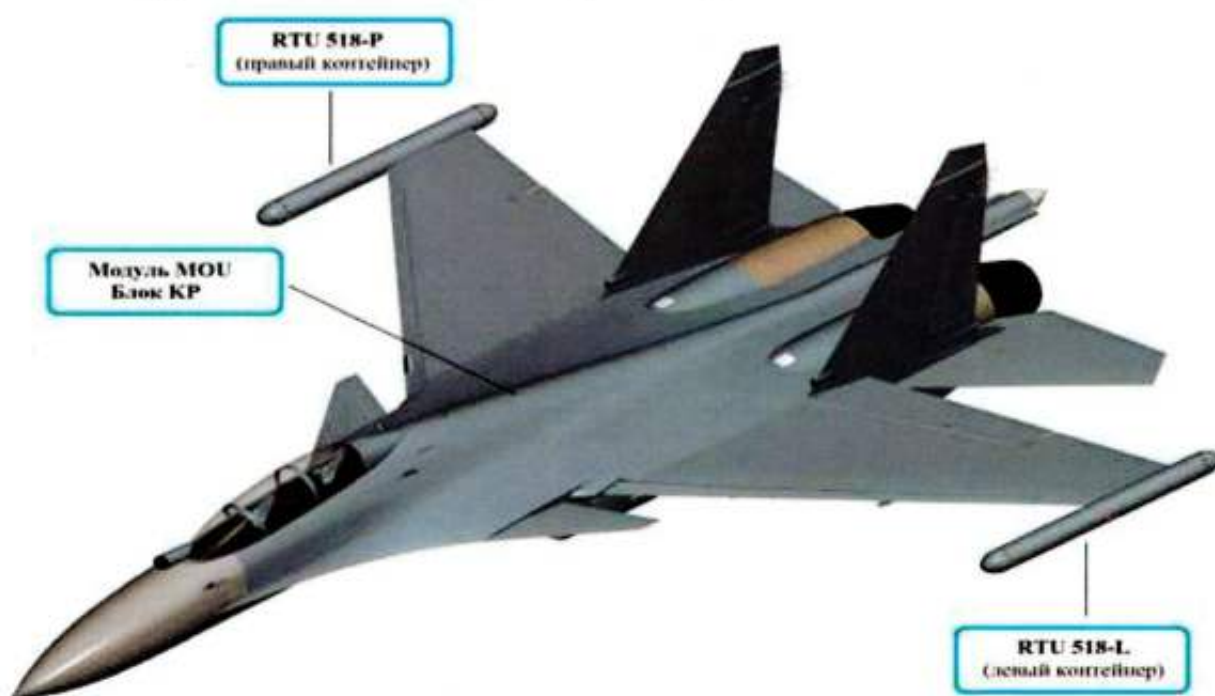
Размещение аппаратуры изделия SAP 518 на самолете Су-30МКМ
