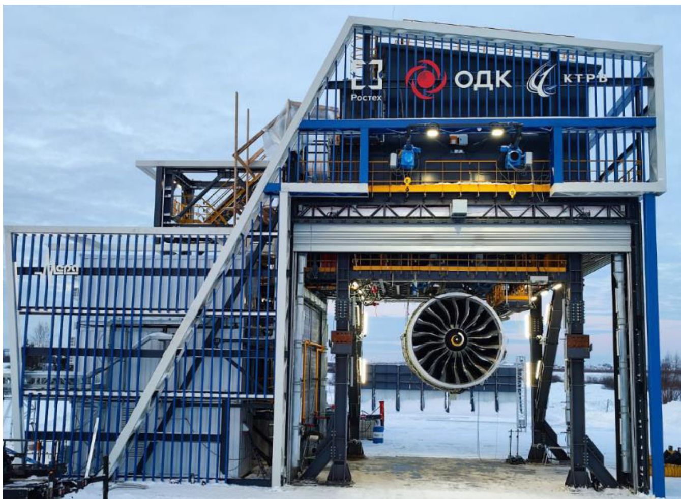
Рисунок 1 – ДДТ ПД-35 на открытом стенде ОС-5 АО «ОДК-Авиадвигатель»
