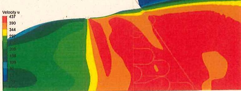
Рисунок 4.5 – Расчетное распределение осевой составляющей скорости
