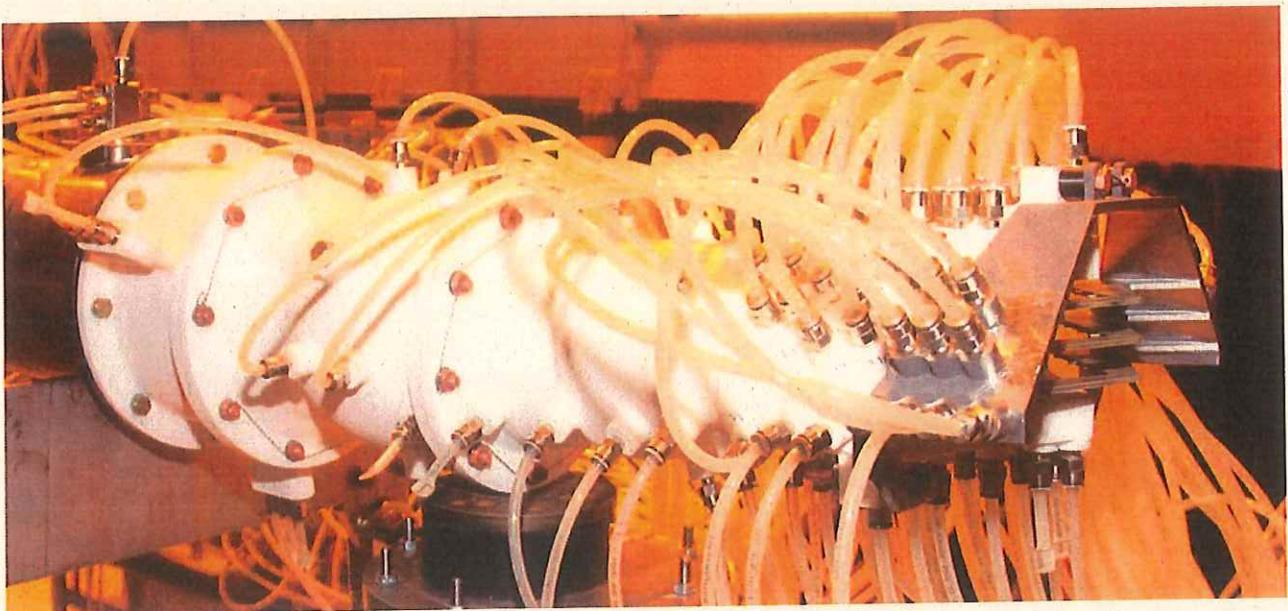
Рисунок 3.1 – Модель в масштабе 1:6,5 на стенде с установленной пневмогребенкой на выходе
