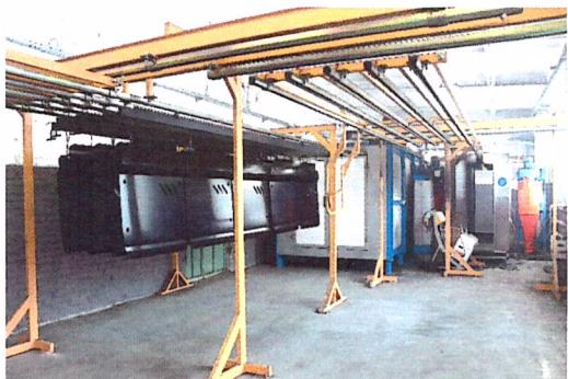
Применение в технологиях лакокрасочных материалов нового поколения при обработке ДСЕ, которые очень критичны к микроклиматическим параметрам воздуха рабочей зоны (температура, влажность, запыленность и т.д.) заставляет ПАО «ОДК-Сатурн» проводить обновление парка
