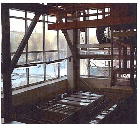
серебрения и линия меднения, цинкования, кадмирования в комплексе с системами водоподготовки и газоочистки.
