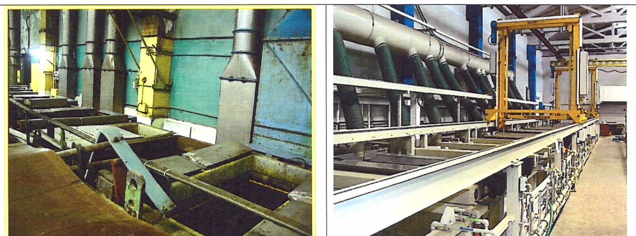
линия анодирования деталей из алюминиевых и титановых сплавов до реконструкции и после.
