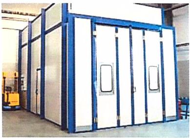
охране труда и пожарной безопасности. Данный участок оснащен поточной линией для нанесения ЛКП (окрасочная камера с контролируемыми микроклиматическими параметрами, камера выдержки деталей на воздухе, сушило, транспортировочная система).
