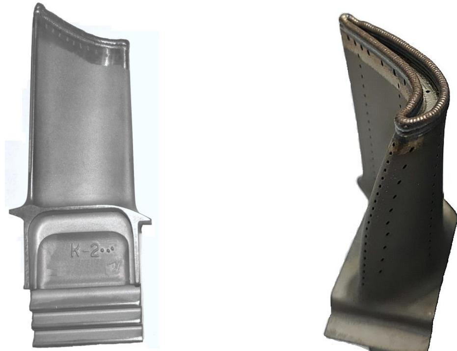
Рисунок 1 – Внешний вид восстановленной рабочей лопатки 1 ступени ТВД
