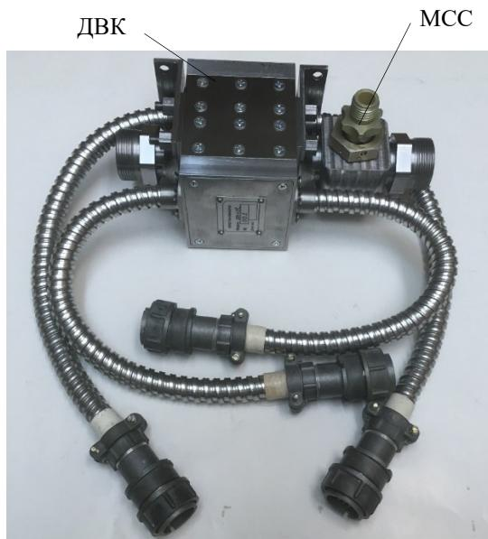
Рисунок 2 – Вихревоковый кластерный датчик частиц изнашивания
