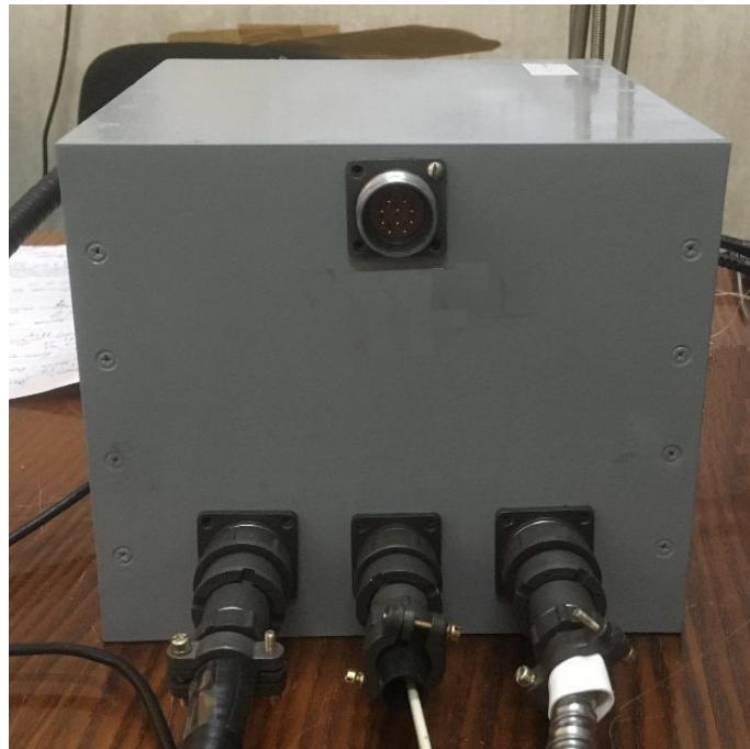
Рисунок 6 – Блок усиления, нормализации, аналого-цифрового преобразования и обработки сигналов ДВКиУС (модель БУНАО)
