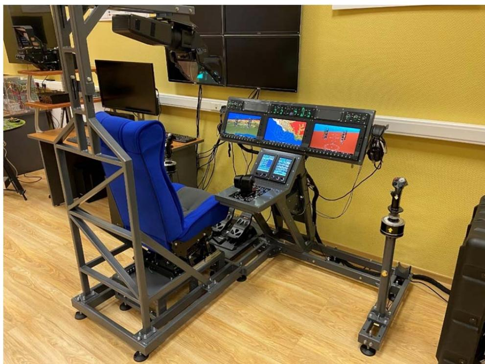
*Рисунок 1 – Внешний вид комплекса бортового оборудования*
