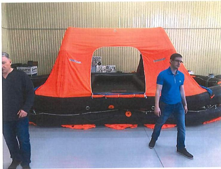
**Макет «Плот надувной спасательный одиннадцатиместный с перегрузкой до семнадцати мест**
