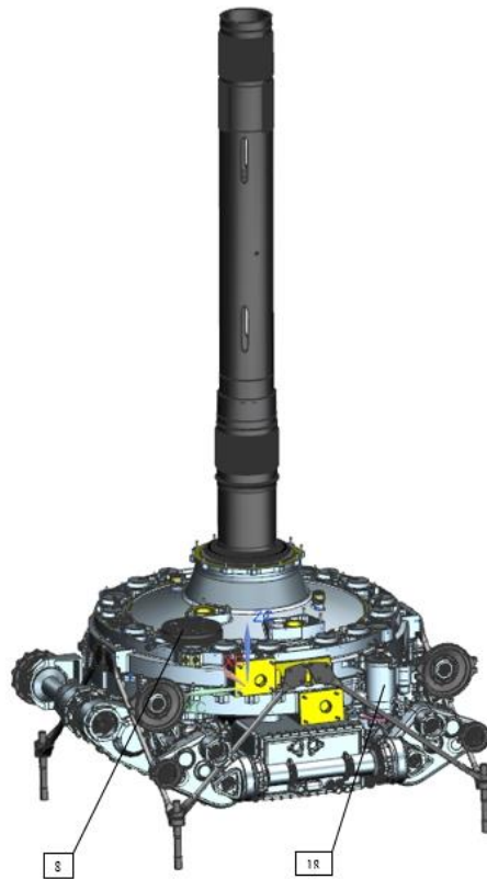
Рисунок 4 – Главный редуктор ВР-450, вид сбоку
