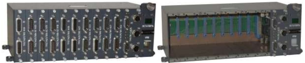
Рисунок 4а - Внешний вид кожуха ТНЗ стандартного размера с модулями (без модулей)приема сигналов (шифр ТНЗ.000)
