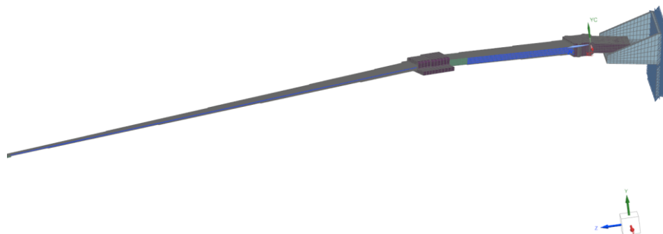
Рисунок 3. Расчетная конечно-элементная модель лонжерона
