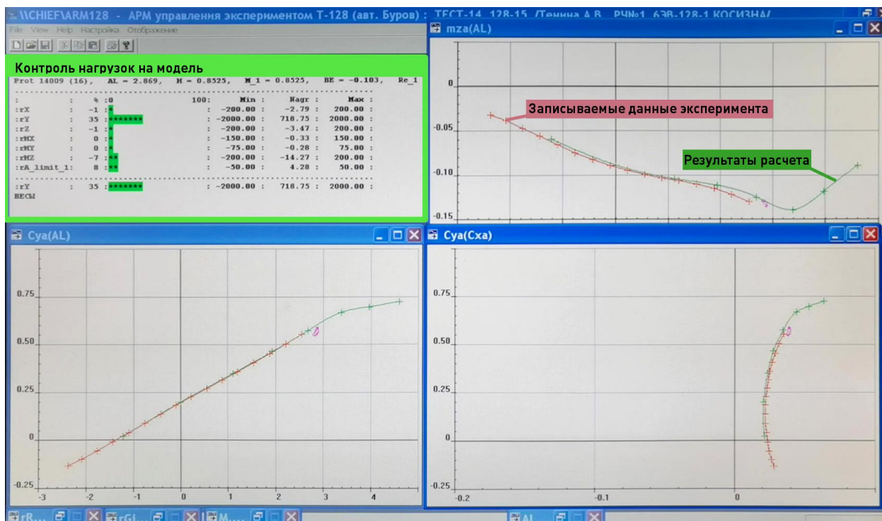
Рис. 4 — Окно программы визуализации данных в реальном времени при испытаниях в АДТ
