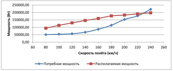
Рисунок 18. График потребной и располагаемой мощностей для максимальной взлетной массы самолёта.
