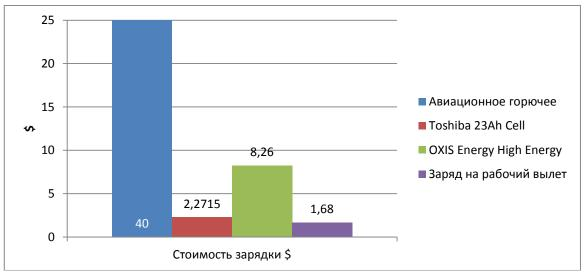
Рисунок 24. Графическое сравнение стоимости заправки топливного бака и стоимость зарядки аккумуляторной батарей самолёта с полностью электрической силовой установкой.
