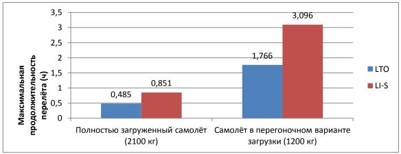
Рисунок 22. Графическое сравнение максимальной расчетной продолжительности горизонтального полёта самолёта в двух вариантах загрузки на двух типах аккумуляторной батареи.
