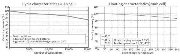
Рисунок 12. Графики жизненного цикла и характеристика саморазрежения литийтитановой ячейки.
