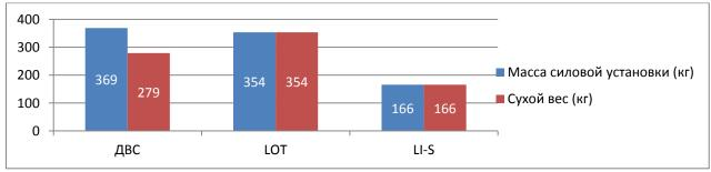
Рисунок 20. Графическое сравнение масс силовых установок.
