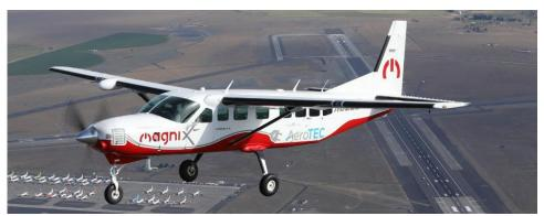
Рисунок 2. Полностью электрический самолет Cessna ECaravan с оборудованием MagniX.
