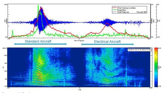
Рисунок 8. Графические данные акустического исследования самолетов с классической и электрической силовой установкой.
