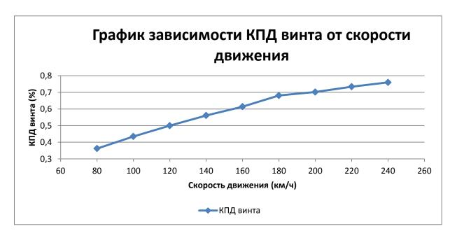
Рисунок 14. График зависимости КПД винта от скорости движения
