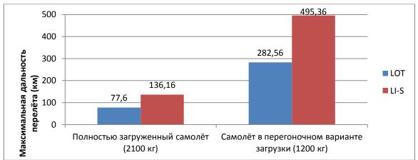
Рисунок 21. Графическое сравнение максимальной расчетной дальности горизонтального полёта самолёта в двух вариантах загрузки на двух типах аккумуляторной батареи.
