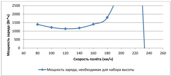
Рисунок 19. Графическое изображение энергии для набора высоты на разных скоростях полёта.
