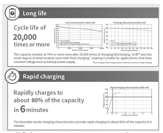
Рисунок 11. Графики жизненного цикла и скорости заряда литий-титановых ячеек корпорации Toshiba.
