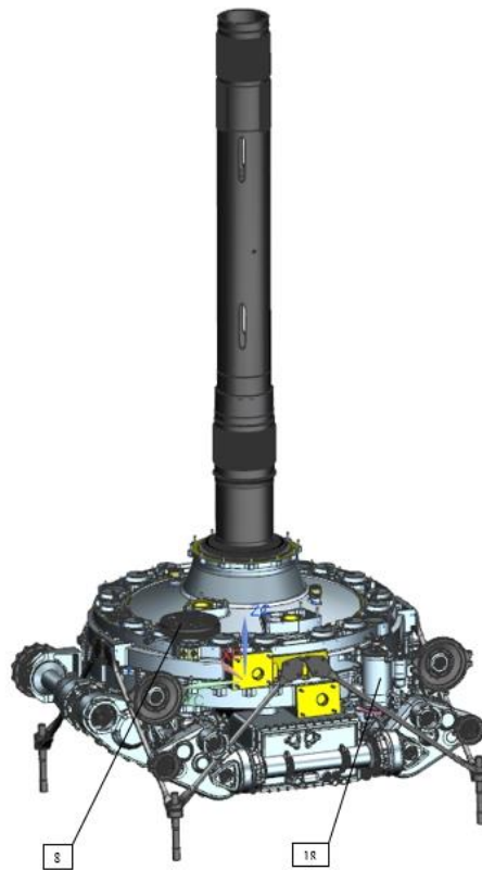
Рисунок 4 – Главный редуктор ВР-450, вид сбоку
