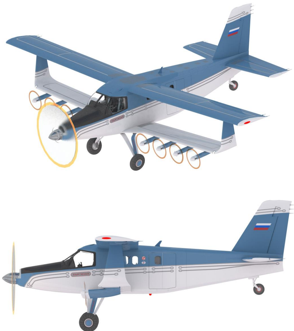
Рисунок 1 – Общий вид беспилотного летательного аппарата самолетного типа сверхкороткого взлета и посадки с гибридной силовой установкой Демонстратор «Партизан»
