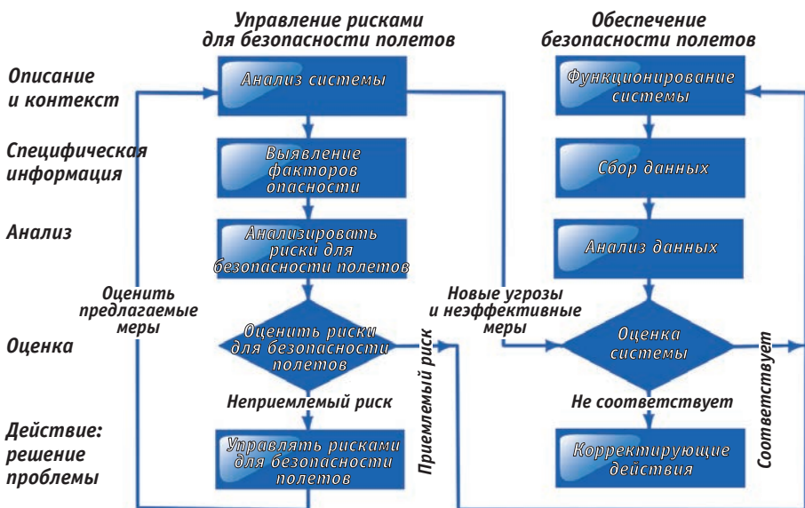
Рис. 2. Схема взаимодействия процессов управления рисками для безопасности полетов и обеспечения безопасности полетов.
