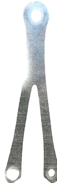
Рисунок 1 – пластина торсиона, изготовленная из стали ВНС9-Ш
