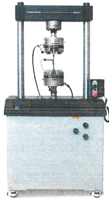
Рисунок 9 - универсальная сервогидравлическая машина Инстрон 8801 для проведения испытаний на статическое растяжение и усталость
