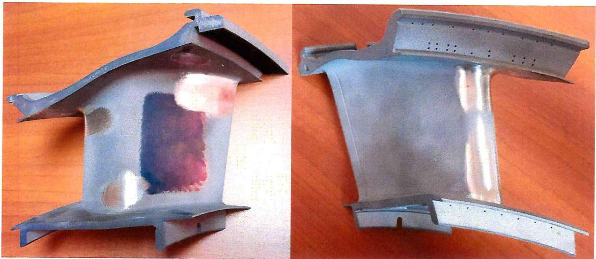
Рисунок 2.9 – Сопловые лопатки ТНД с относительной толщиной профиля 18 и 25 % с восстановленными углублениями под базовые точки
