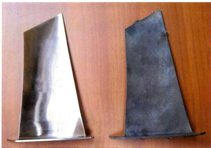
Рисунок 1.7 – Готовая лопатка и её заготовка для определения предела выносливости
