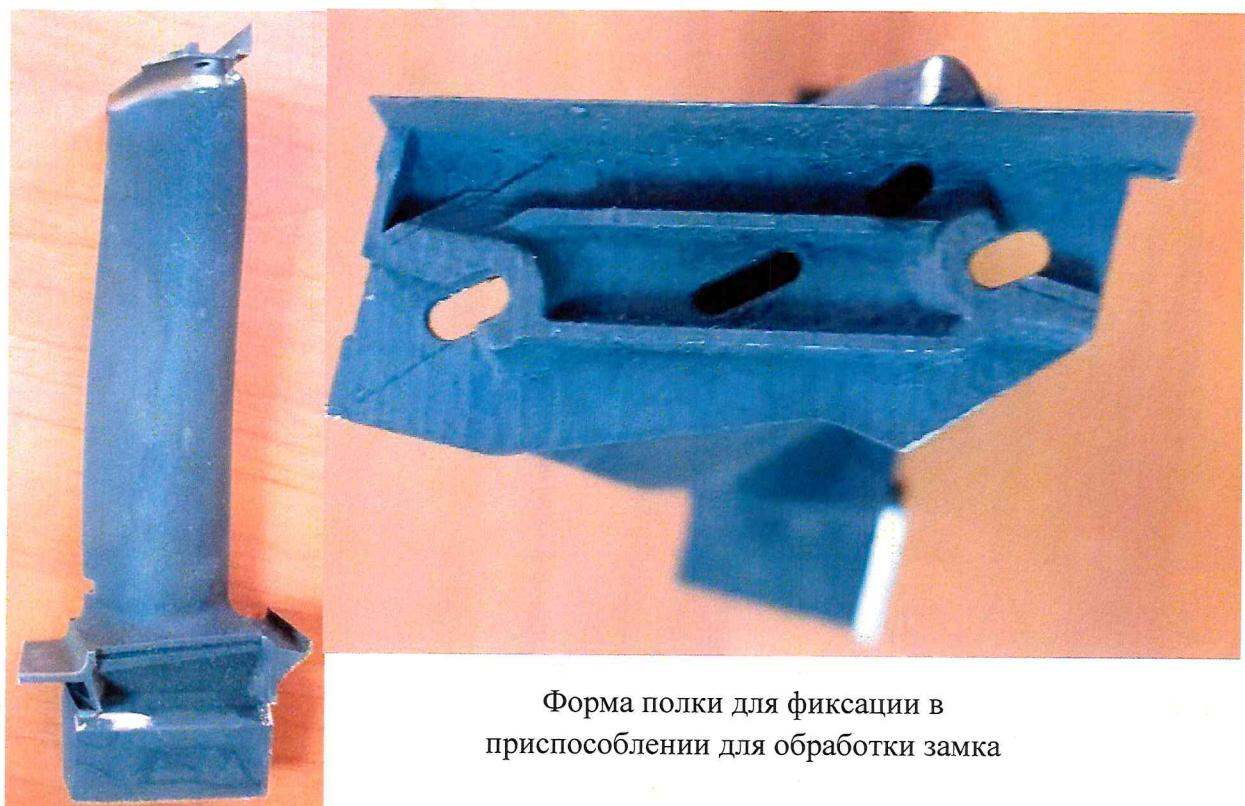
Форма полки для фиксации в приспособлении для обработки замка
