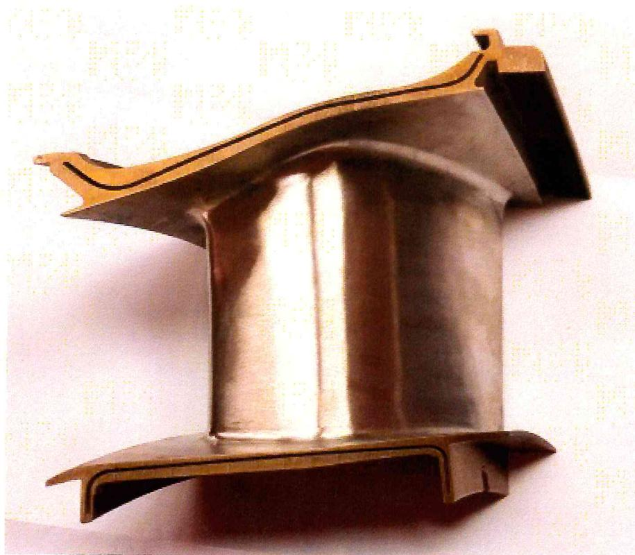
Рисунок 2.10 – Сопловая лопатка ТНД после механической обработки
