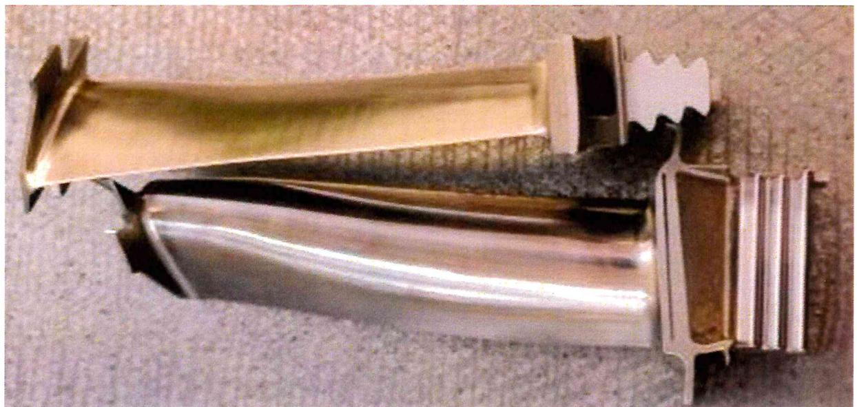
Рисунок 2.13 – Рабочие лопатки ТНД после механической обработки
