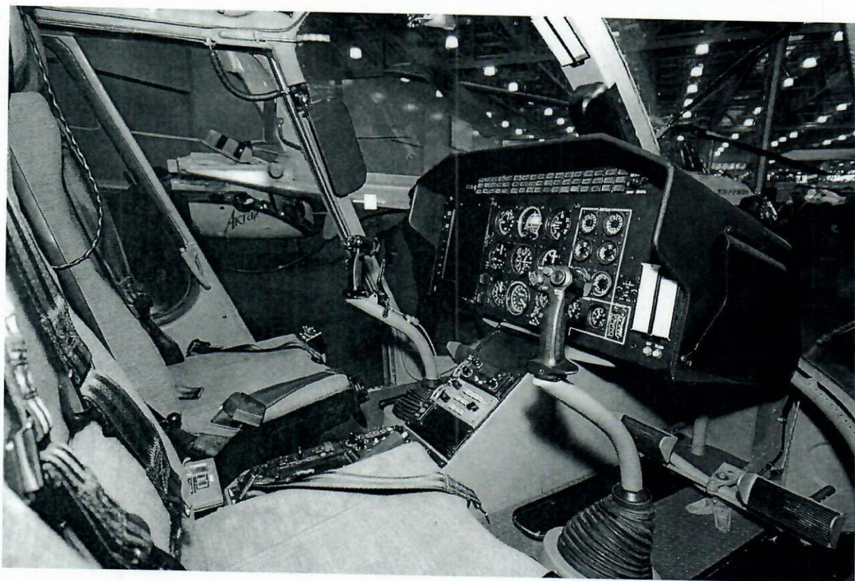
Рисунок 4 – Кабина пилотов вертолета Ка-226Т
