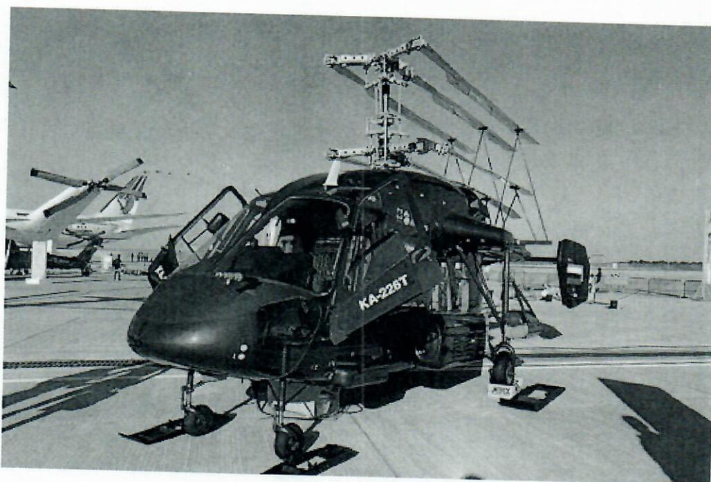
Рисунок 1 - Внешний вид вертолета Ка-226Т (исполнение 226.54) с установленной СКВ в контейнере.
