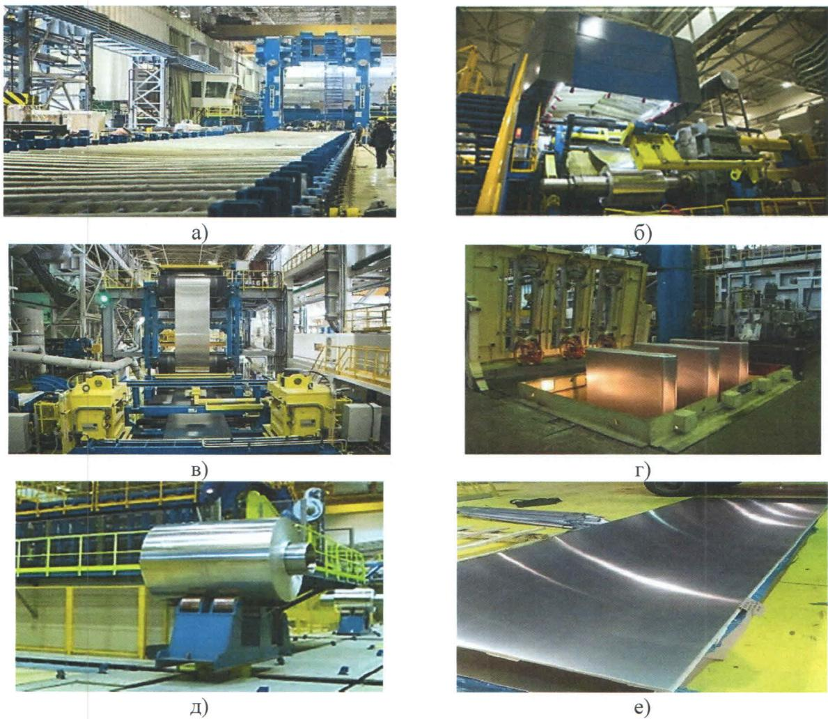
Рисунок 1 – Двухклетевой стан горячей прокатки (а), шести валковый нереверсивный стан холодной прокатки (б), линия непрерывной термической обработки (в), крупногабаритные плоские слитки (г), внешний вид смотанного рулона (д), внешний вид широких обшивочных плакированных листов (е)
