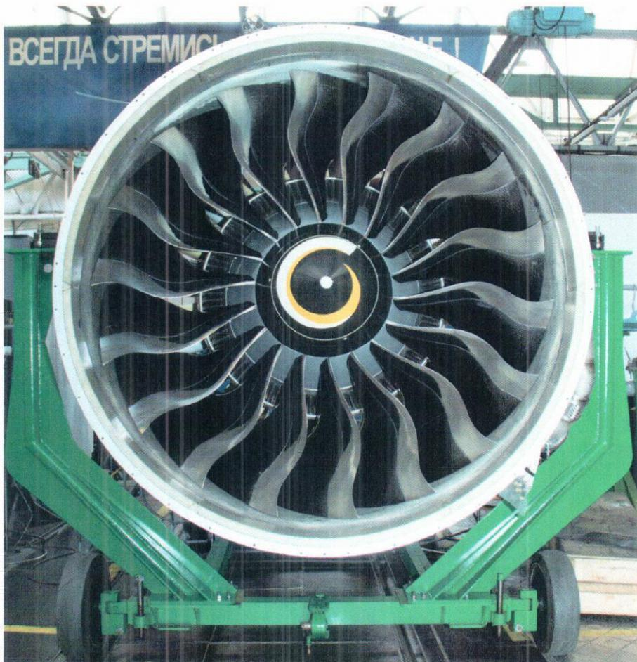
Рисунок 1 –Двигатель ПД-14 с РЛ вентилятора из ПКМ
