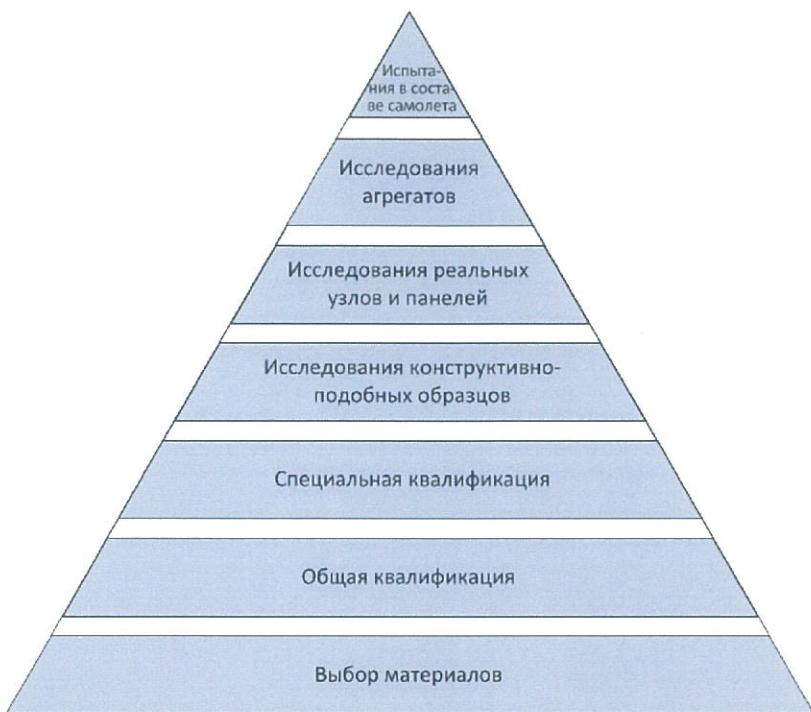
Рисунок 1 – Общая схема пирамиды расчетно-экспериментальных исследований
