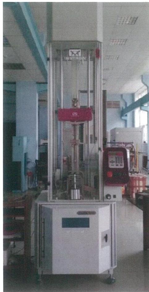
Рисунок 12- Испытательная установка для нанесения повреждений
