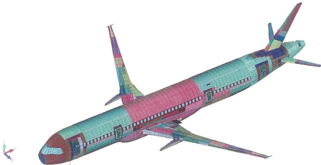
Рисунок 30 – Глобальная конечно-элементная модель планера магистрального самолета
